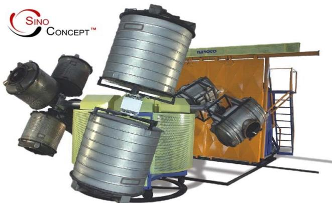
Technique qui est utilisée pour la fabrication de corps creux, de toutes dimensions mais plus particulièrement de grande contenance. On utilise de la poudre car si on utilise du granulé il faudrait plus d'énergie pour le fondre et le temps de cuisson serait trop long. Le rotomoulage permet d'introduire de la matière dans un moule, celui-ci va rentrer en rotation dans le four, la matière va fondre et prendre la forme du moule puis la pièce va être refroidie et éjectée.
